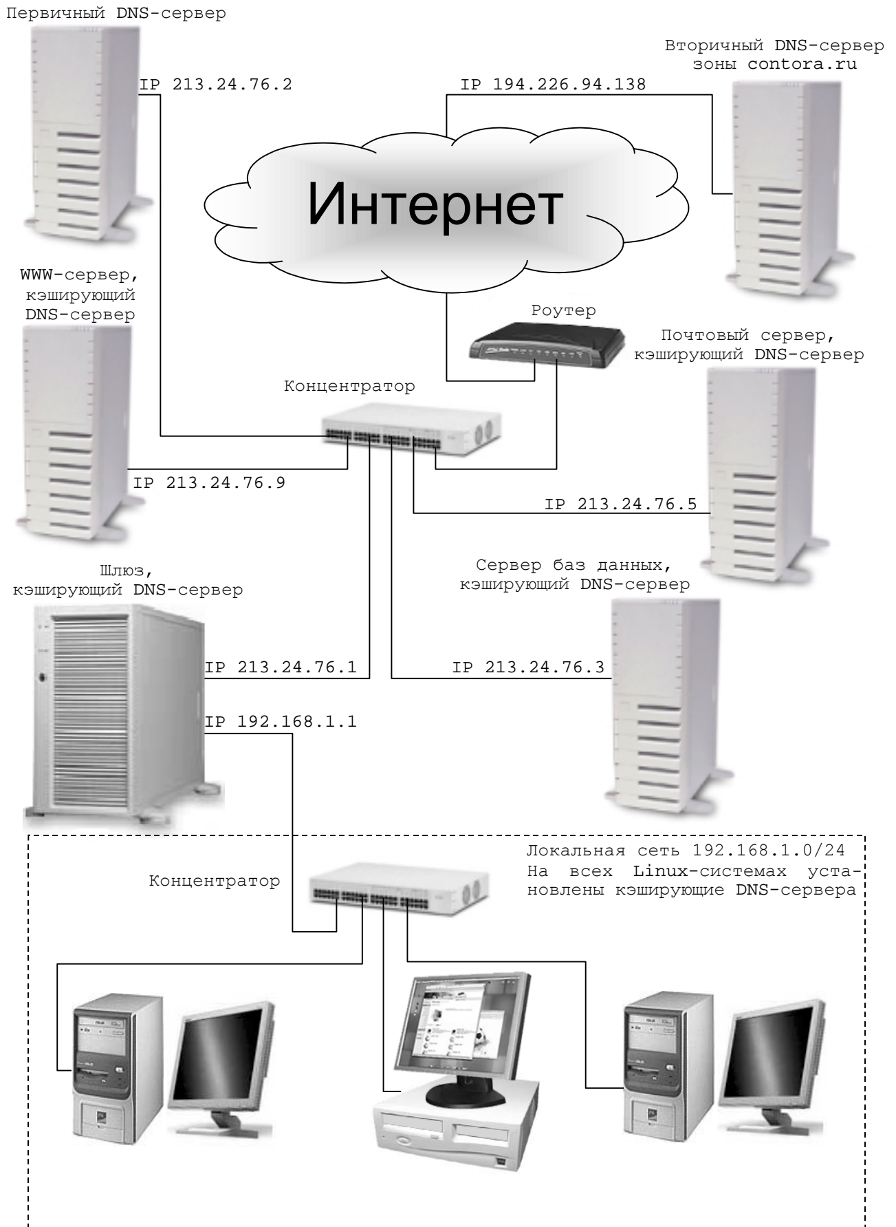
Рис. 23.1 Принципиальная схема организации службы DNS.
