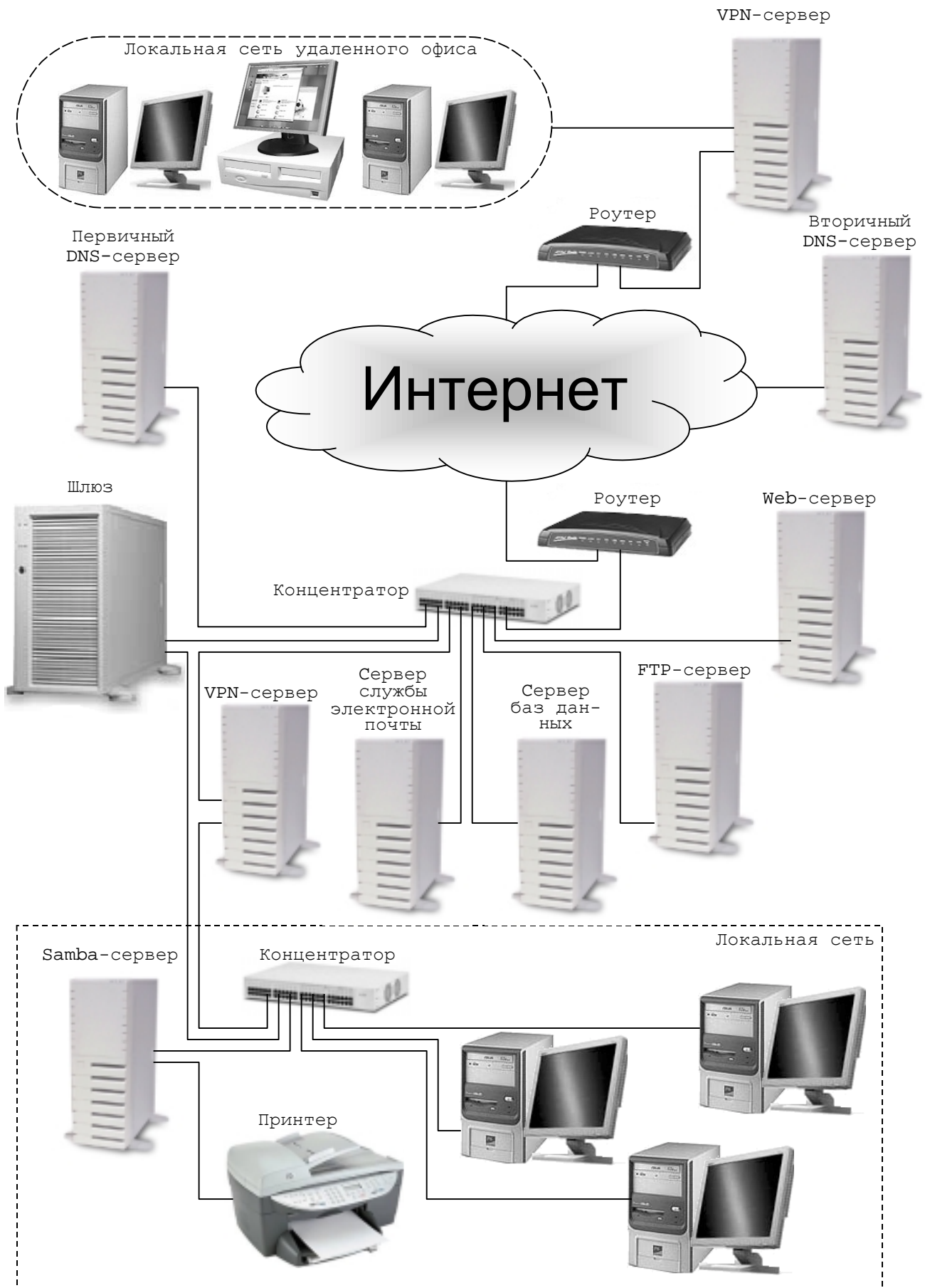
Рис. 1.1. Обобщенная схема организации корпоративной сети предприятия
